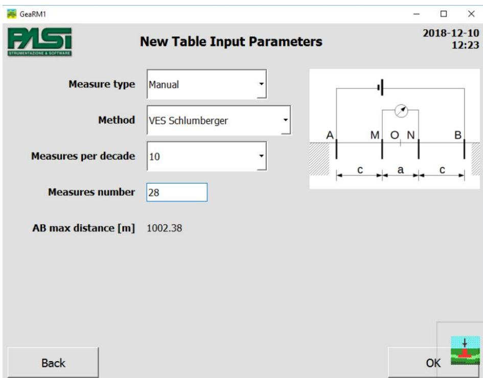
FIGURE 3 - INSERT THE DESIRED PARAMETERS FOR THE CREATION OF A NEW TABLE
