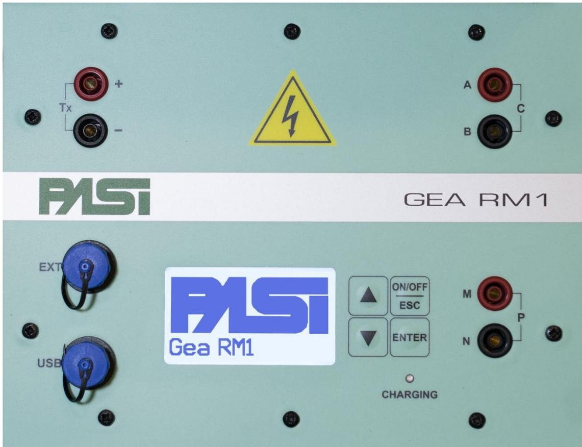
FIGURE 13 - FRONT PANEL OF THE GEA RM1 SYSTEM
