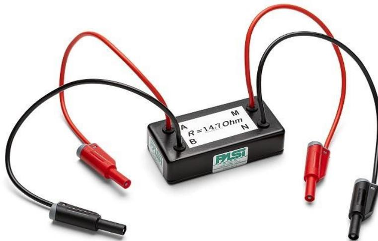
Eseguendo la misura (dopo aver collegato A, B, M, N alle rispettive prese sul georesistivimetro e dopo aver collegato l'energizzatore al georesistivimetro), il rapporto  $\Delta V/I$  deve essere uguale al valore di  $R_2$  indicato, quindi  $15 \Omega \pm 10\%$ .
