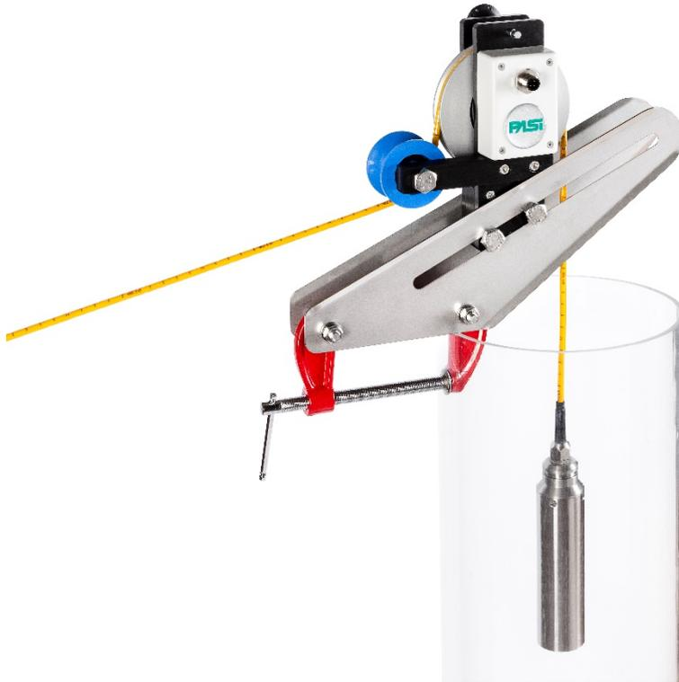
**FIGURE 4 - ENCODER PROPERLY INSTALLED**
