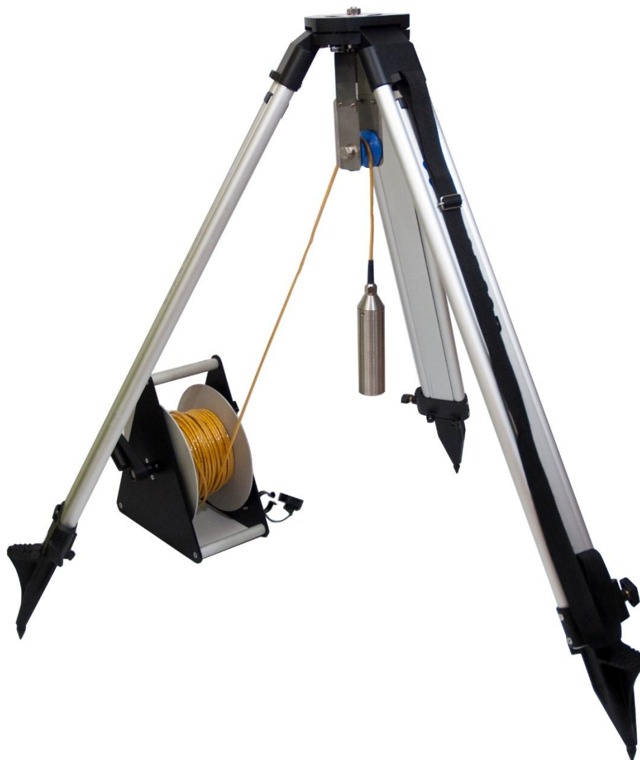
FIGURA 11 - TREMPIEDE DI SOSPENSIONE CON PULEGGIA
